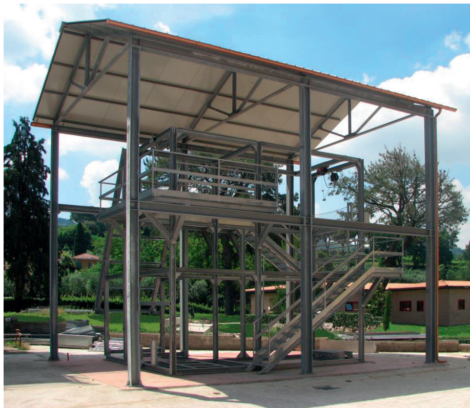
Fig. 6.2-1 Attrezzatura di prova - Struttura metallica rigida
